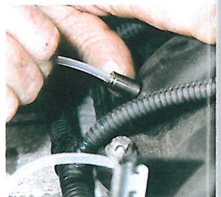
6. Die Additivschläuche mit den Steckanschlüssen...
