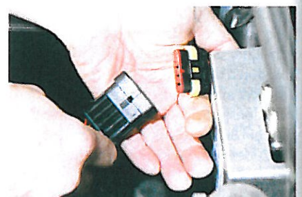
3. Der fünfpolige Stecker wird wie folgt angeschlossen: braun: Eingang Füllstandssensor Additivtank gelb: Signalausgang LED rot: zwölf Volt bei Gasbetrieb violett: Steuerader einer beliebigen Gas-Einspritzdüse weiß: geschalteter Masseausgang Der geschaltete Masseausgang ist bis zu drei Ampere belastbar und kann zur Schaltung eines Relais oder einer Ventilschule (wie Tankfreigabeventil oder Verdampferfreigabeventil) genutzt werden. Er verhindert so den Gasbetrieb bei leerem Additivtank.
