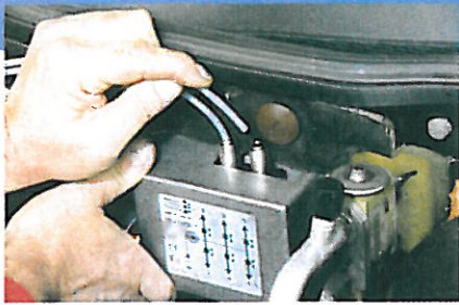
7. ...und das andere Ende mit dem Additiv-Dosiermodul verbinden.
