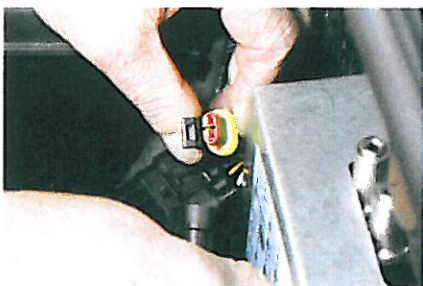
4. Der zweipolige Stecker wird wie folgt angeschlossen: braun: Masse grau: Zwölf Volt Zündplus (Klemme 15)
