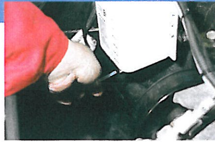
8. Die Zuleitung vom Additivbehälter zum Dosiermodul erfolgt ebenfalls über einen Schlauch in Steckverbindungen.
