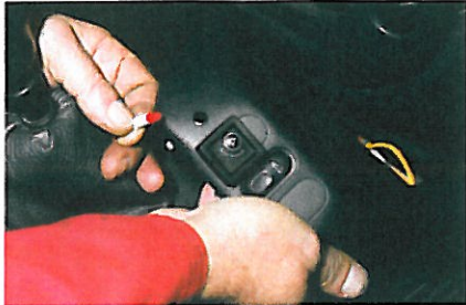
10. Die LED-Signalleuchte einbauen, hier bietet sich der untere Teil der Mittelkonsole neben der Gas-Anzeige an. Ab einer Restmenge von 100 Millilitern blinkt die LED langsam, blinkt sie schnell, ist das System leer. Leuchtet die kleine Lampe dauerhaft, liegt ein Systemfehler vor.
