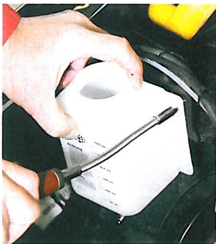
1. Vor Beginn aller Arbeiten gilt es, einen geeigneten Platz für die einzelnen Komponenten des Additiv-Dosiersystems zu finden. Der Additiv-Behälter passt sehr gut vorne rechts in den Motorraum. Er sollte an einer gut zugänglichen Stelle und nicht zu nah am Motor montiert sein, damit er keinen höheren Umgebungstemperaturen als 80 Grad Celsius ausgesetzt ist.
