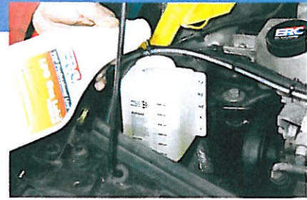
9. Additivbehälter auffüllen. Der kleine Tank ist mit einem Füllstandssensor ausgerüstet, der Schlauchanschluss ist in alle Richtungen drehbar. Der Additivtank benötigt eine Ventilationsöffnung, die sich oben am Verschluss befindet. Er sollte daher nicht höher als bis zur 600-Milliliter-Marke aufgefüllt sein, damit kein Additiv austritt.
