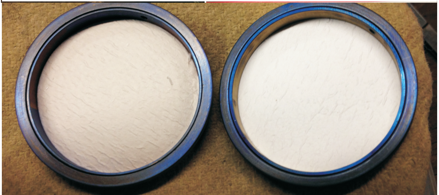
Rußzahlmessung nach VDI 2066 im mit HEL betriebenen Kraftwerk Oldendorf (Gasturbine C): Links oben Versuche 1 und 3, rechts oben Versuche 4 und 6, unten Versuch 7
