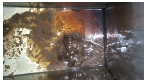
Bakterien, Pilze und Hefen in Biokraftstoffen führen zu grotesken Ablagerungen im Tank.
